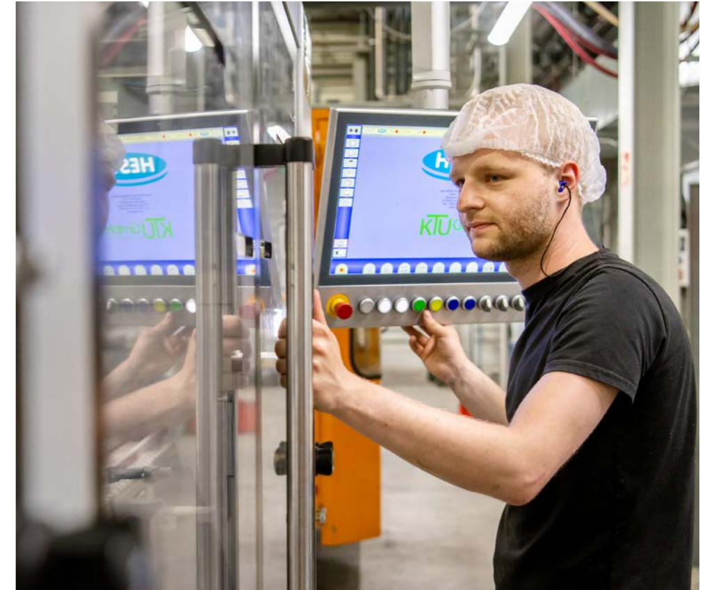
High-Tech trifft Kunststoff. Ernst Motschmann kontrolliert regelmäßig die Flaschen-Produktion in der Extrusionsblasmaaschine.
