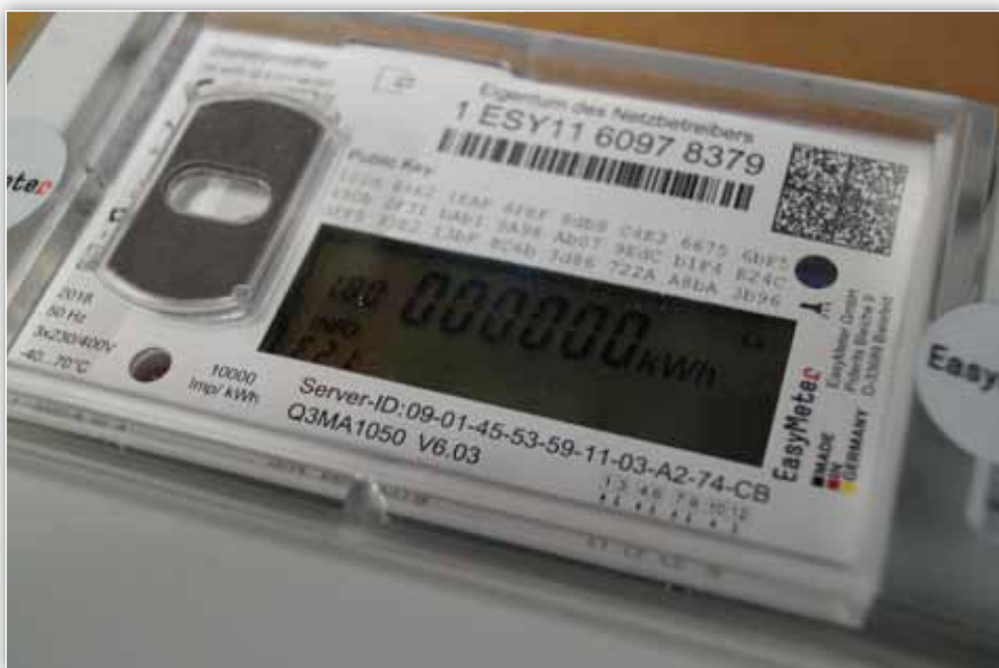
1-Tarifzähler, wie er im Netzgebiet der EnR Energienetze Rudolstadt GmbH eingebaut wird
